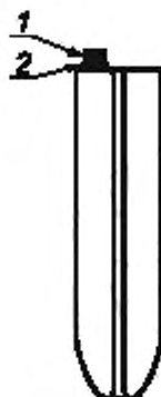
1 — заглушка из нержавеющей стали; 2 — шайба из фтороуглеродистого тетрафторэтилена
