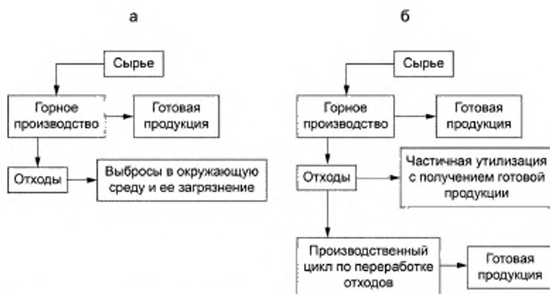
Рисунок 7.1 — Обычная (а) и безотходная (б) технологические схемы освоения недр
