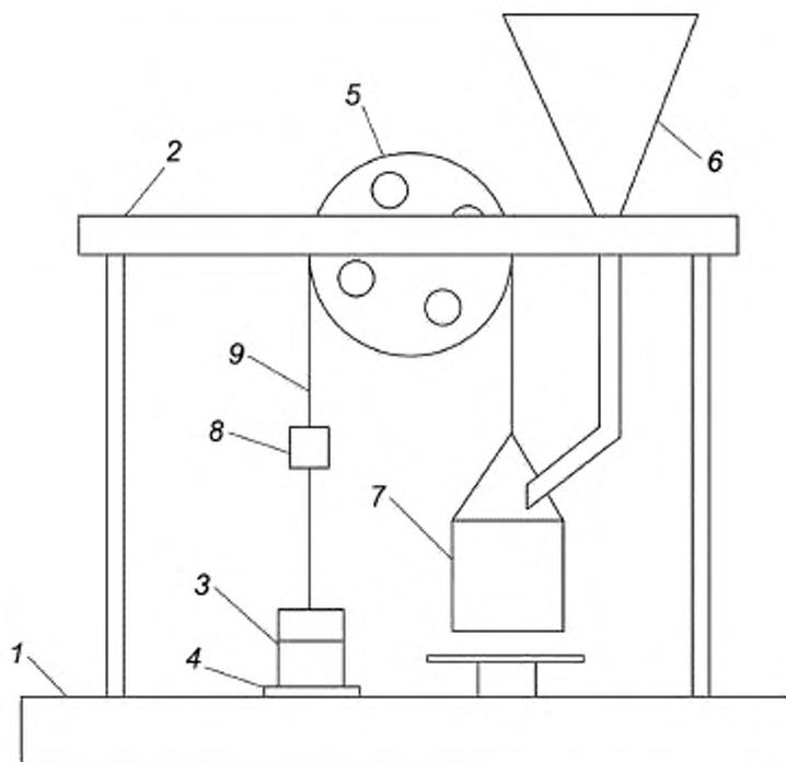
1 — основание; 2 — стойка; 3 — форма для грунта; 4 — полозья для формы; 5 — блок; 6 — воронка; 7 — ведро для груза; 8 — штамп с противовесом для уравновешивания формы для грунта и ведерка и площадкой для груза; 9 — струна
