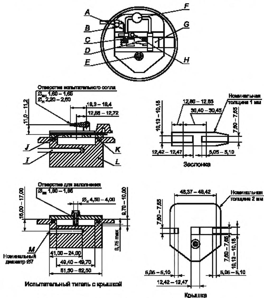
А — детектор вспышки; В — крышка; С — сопло запального пламени; D — сопло испытательного пламени; E — отверстие для заполнения; F — винт регулировки испытательного газового пламени; G — заслонка; H — шаблон испытательного пламени; J — термометр; K — центровочный паз детектора вспышки; L — кольцевое уплотнение крышки; M — карман для термометра
