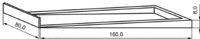
Рисунок 1 — Форма-рамка для изготовления образцов при определении стойкости к образованию усадочных трещин
