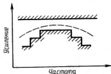
Минимальное и максимальное значения коэффициента усиления в зависимости от частоты
