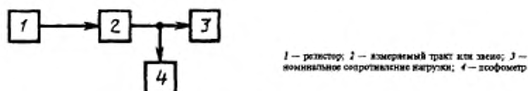
Рисунок 5 — Структурная схема измерения взвешенного шума
