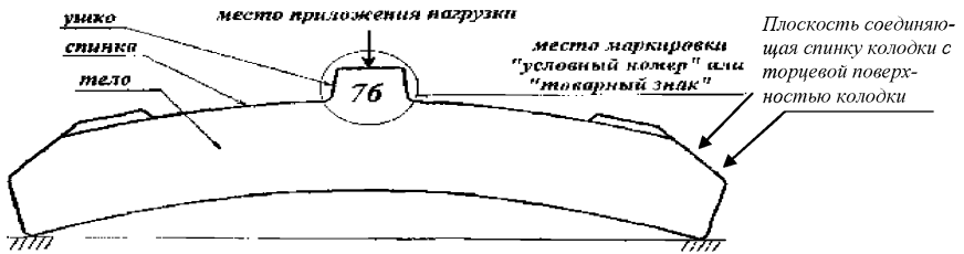
Рисунок 1 - Схема испытания на излом тормозной колодки и место расположения маркировки «условный номер» или «товарный знак» предприятия-изготовителя
