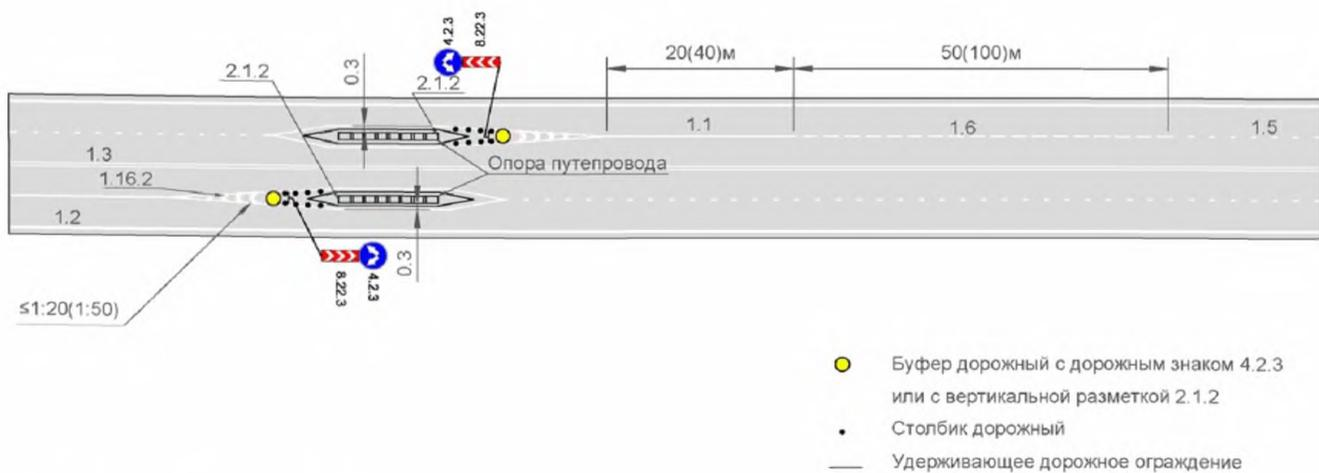
Рисунок Г.24 – Примеры применения элементов обустройства в местах сужения дорог, лист 1
