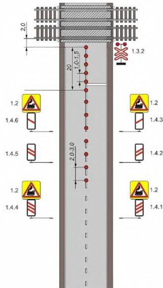
Рисунок Г.30 – Пример размещение сигнальных столбиков на подходе к железнодорожному переезду
