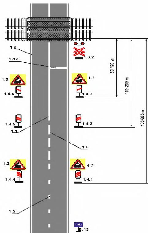
Рисунок Г.26 – Примеры применения элементов обустройства железнодорожного переезда, лист 1
