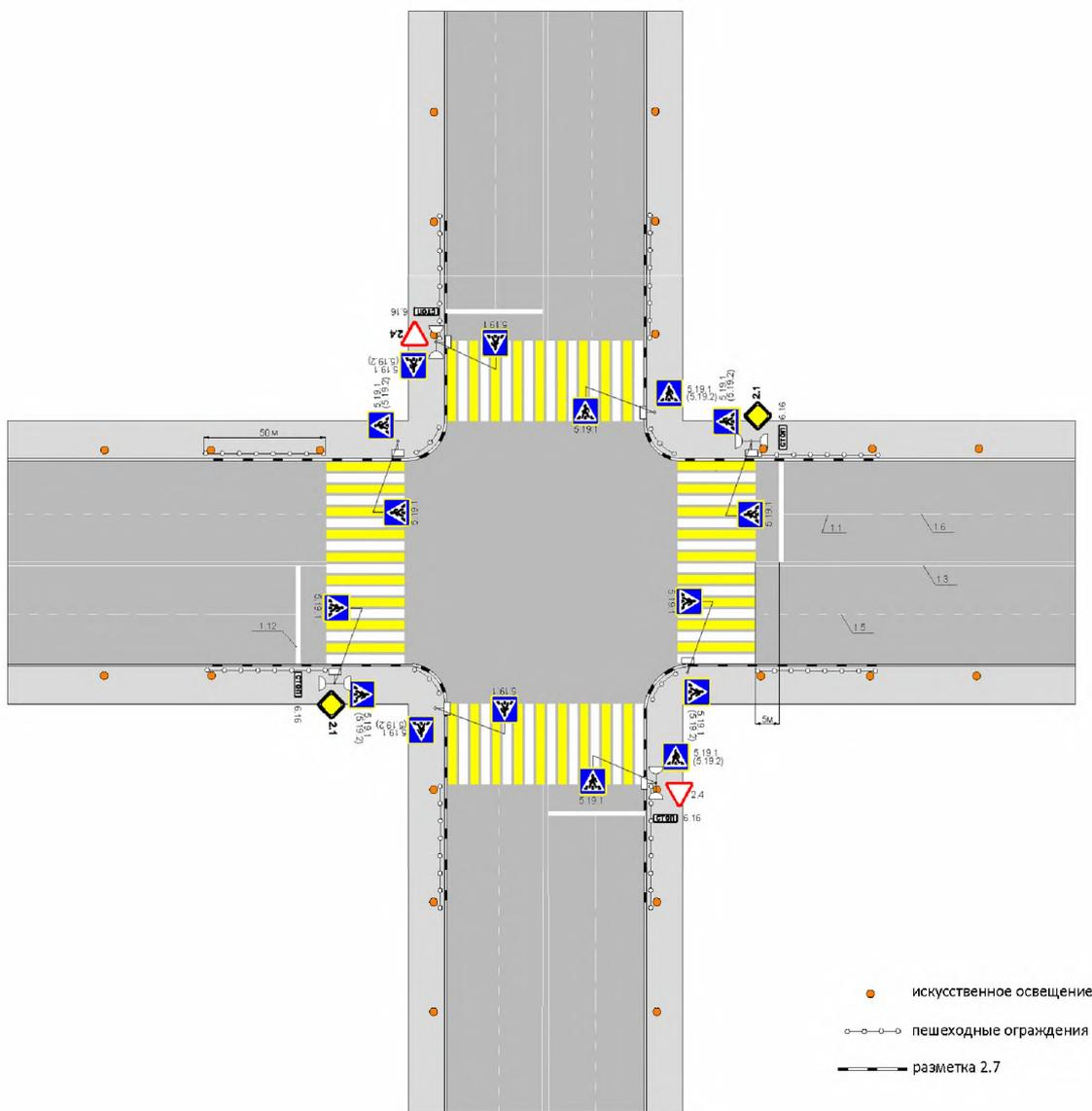
Рисунок Г.5 – Пример применения элементов обустройства на регулируемом пересечении
