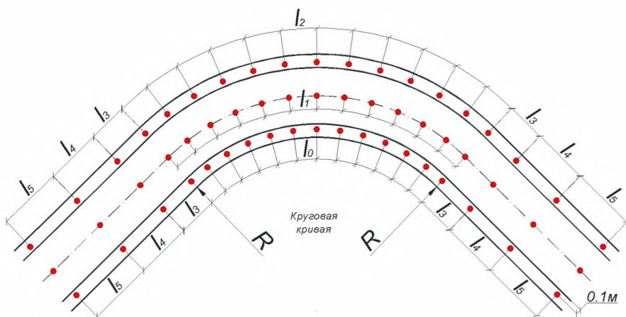
Рисунок Г.22 – Схема установки световозвращателей типа КДЗ на кривой в плане
