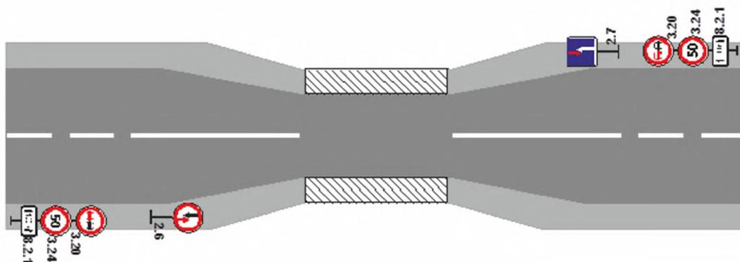
Рисунок Г.31 – Типовая схема применения знаков 2.6 и 2.7 на узких участках дороги
