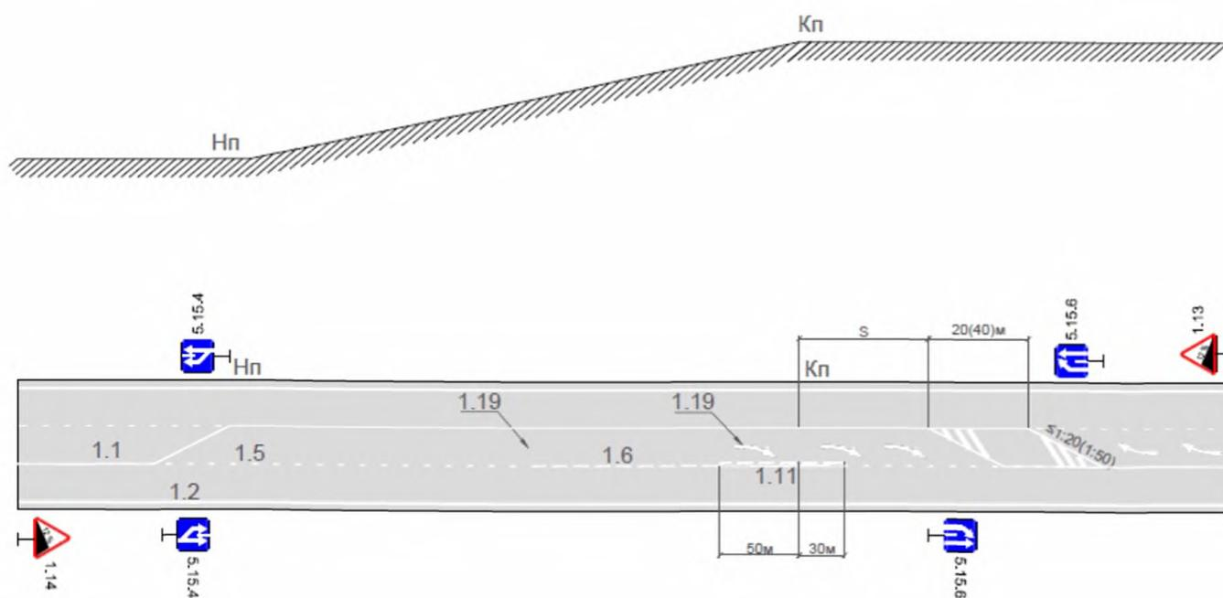
Рисунок Г.19 – Примеры применения элементов обустройства в местах спусков и подъемов, лист 1
