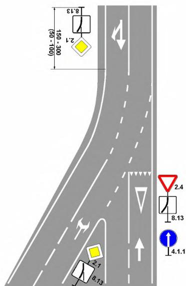
Рисунок Г.3 – Пример применения ТСОДД на перекрестке при изменении направления главной дороги
