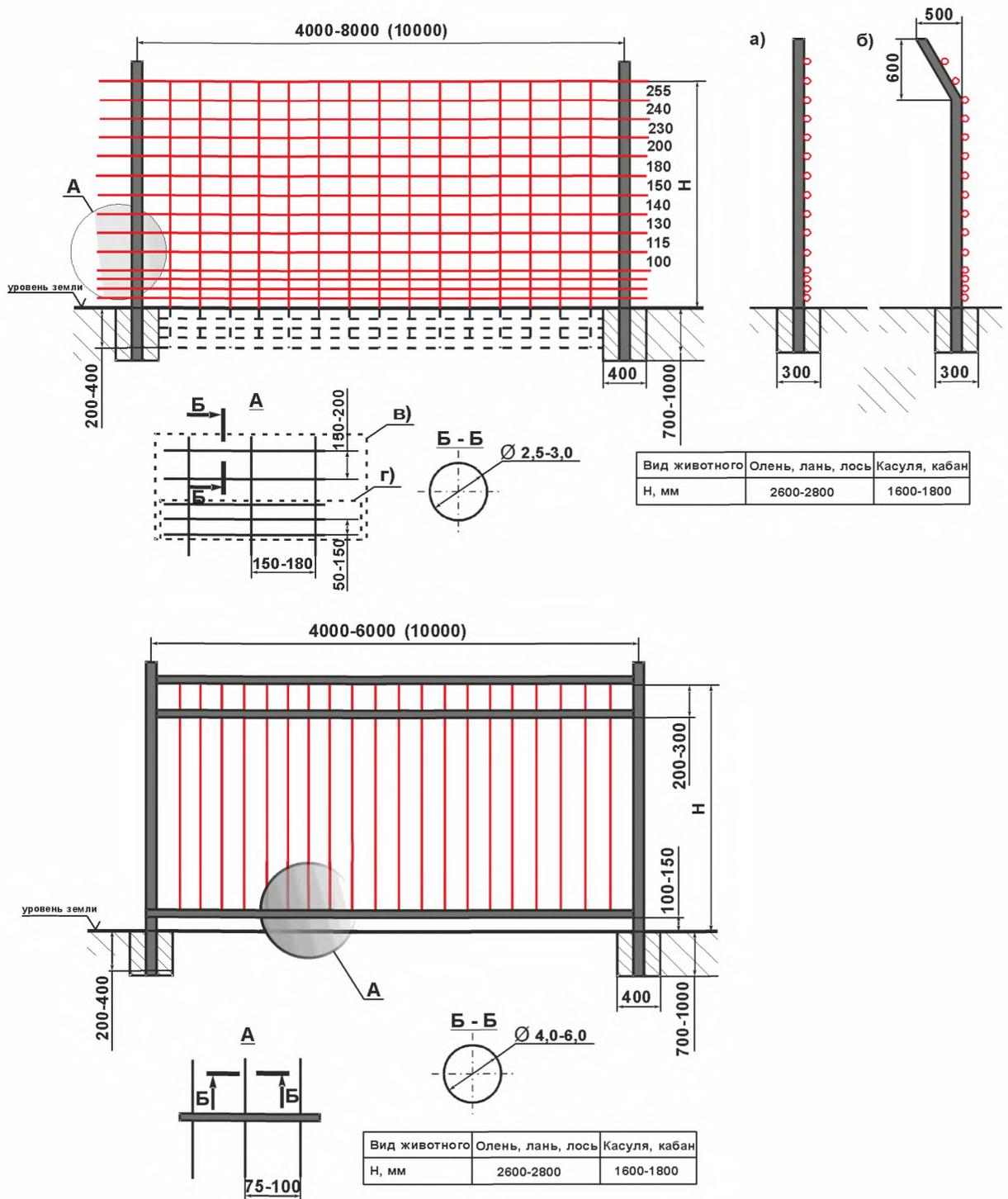
Рисунок Б.1 – Типовые конструкции ограждений сетчатого и решетчатого типа: а) без козырька; б) с козырьком; в) без дополнительного ограждения в нижней части; в) с дополнительным ограждением в нижней части
