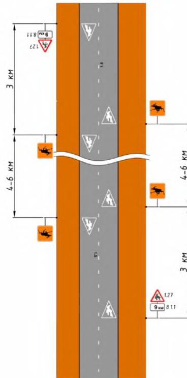
Рисунок Г.2 – Пример обустройства щитами участка двухполосной дороги более 3 км
