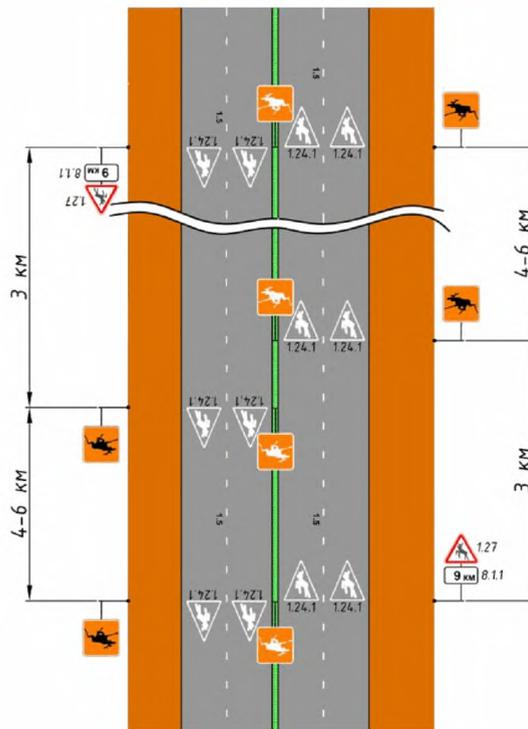
Рисунок Г.3 – Пример обустройства щитами участка многополосной дороги более 3 км
