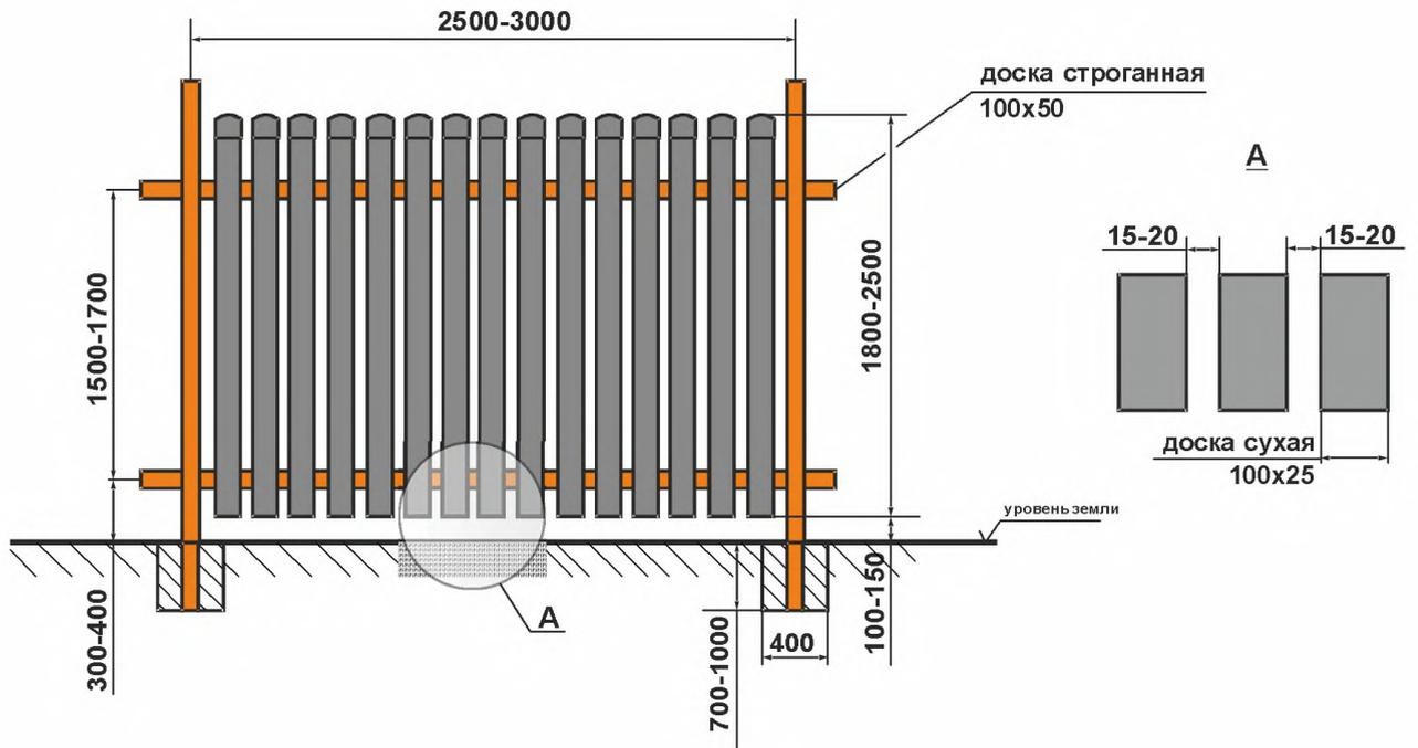
Рисунок Б.2 – Типовая конструкция ограждения деревянного типа
