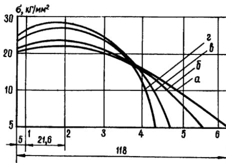
Рис. 4. Эпюры распределения напряжений вала-шестерни в редукторе комбайна ИКЮИ при различных усилиях кручения корпуса
