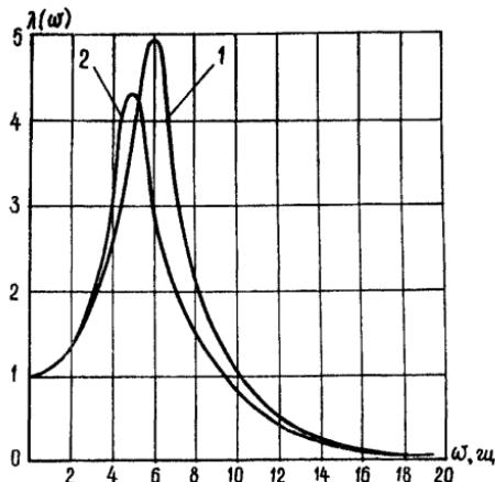
Рис. 7. Графики АЧХ колебаний корпуса комбайна БК-52
