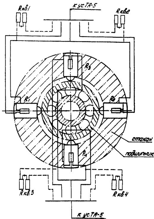
Рис. 5. Схема соединений резисторов в тензометрическом стакане, смонтированном в редукторе комбайна ИК101
