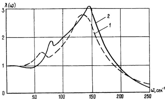
Рис. 6. Графики АЧХ трансмиссии комбайна БК-52
