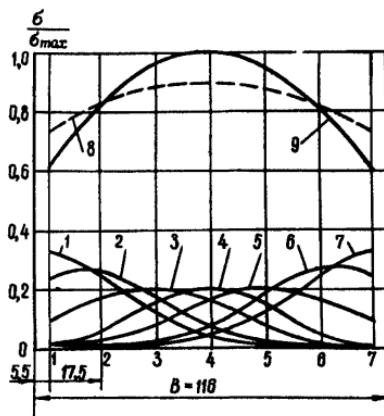
Рис. 2. Эпюры распределения напряжений зубчатого колеса, установленного на гидропульсаторе:
