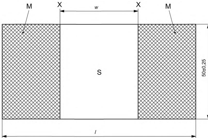
М — расположение захвата; S — испытуемая полезная область; X — отсчетная линия; w — ширина испытуемой области (45 или 55 мм); l — длина образца для испытания [(100 ± 0,25) или (110 ± 0,25) мм]
