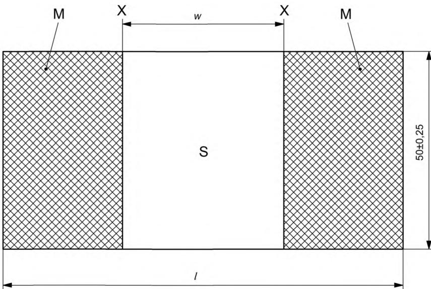
М — расположение захвата; S — испытуемая полезная область; X — отсчетная линия; w — ширина испытуемой области (45 или 55 мм); l — длина образца для испытания [ $(100 \pm 0,25)$  или  $(110 \pm 0,25)$  мм]
