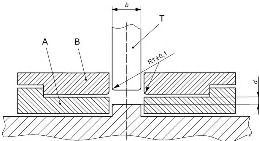
А — нижний зажим; В — верхний зажим; Т — прижимное устройство;  $d$  — расстояние между основанием и верхней поверхностью нижнего зажима [см. 4.2, перечисление б)];  $b$  — ширина прижимного устройства [см. 4.2, перечисление е)]
