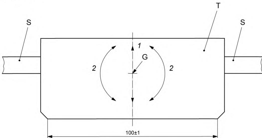
1 — вертикальное смещение; 2 — смещение вокруг центра тяжести G; S — направляющая система прижимного устройства;
