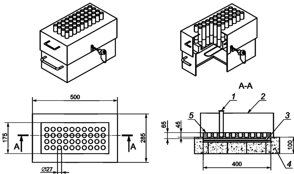
1 — пробирка; 2 — подставка для пробирок; 3 — нагреватель; 4 — изоляционный материал; 5 — алюминиевый блок
