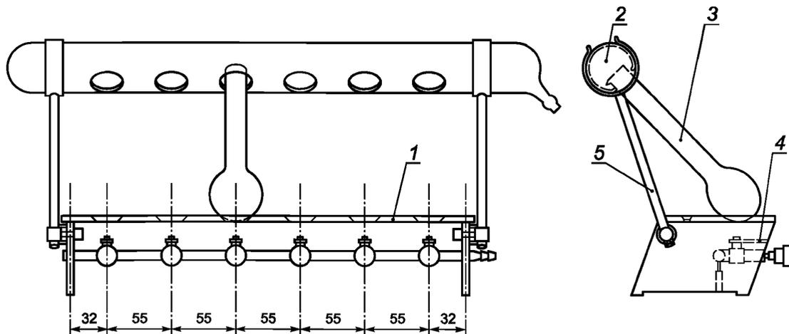
1 — полка из термостойкого теплоизоляционного материала; 2 — выпускная трубка; 3 — колба для кипячения; 4 — микрорегулька; 5 — опорный стержень с регулировкой угла наклона и длины
