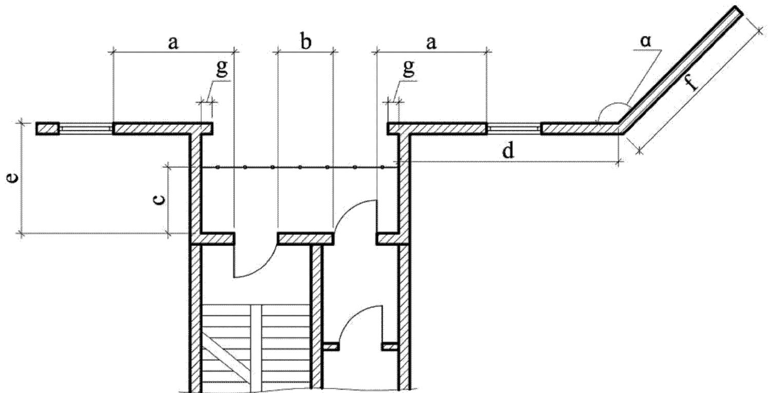
Рисунок 8 – Поэтажные переходы через наружную воздушную зону к незадымляемым лестничным клеткам типа Н1
