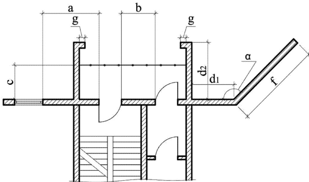
Рисунок 7 – Поэтажные переходы через наружную воздушную зону к незадымляемым лестничным клеткам типа Н1 по балконам без сплошных ограждений
