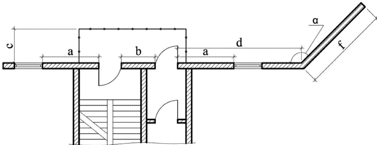
Рисунок 6 – Поэтажные переходы через наружную воздушную зону к незадымляемым лестничным клеткам типа Н1 по балконам с торцевыми сплошными ограждениями
