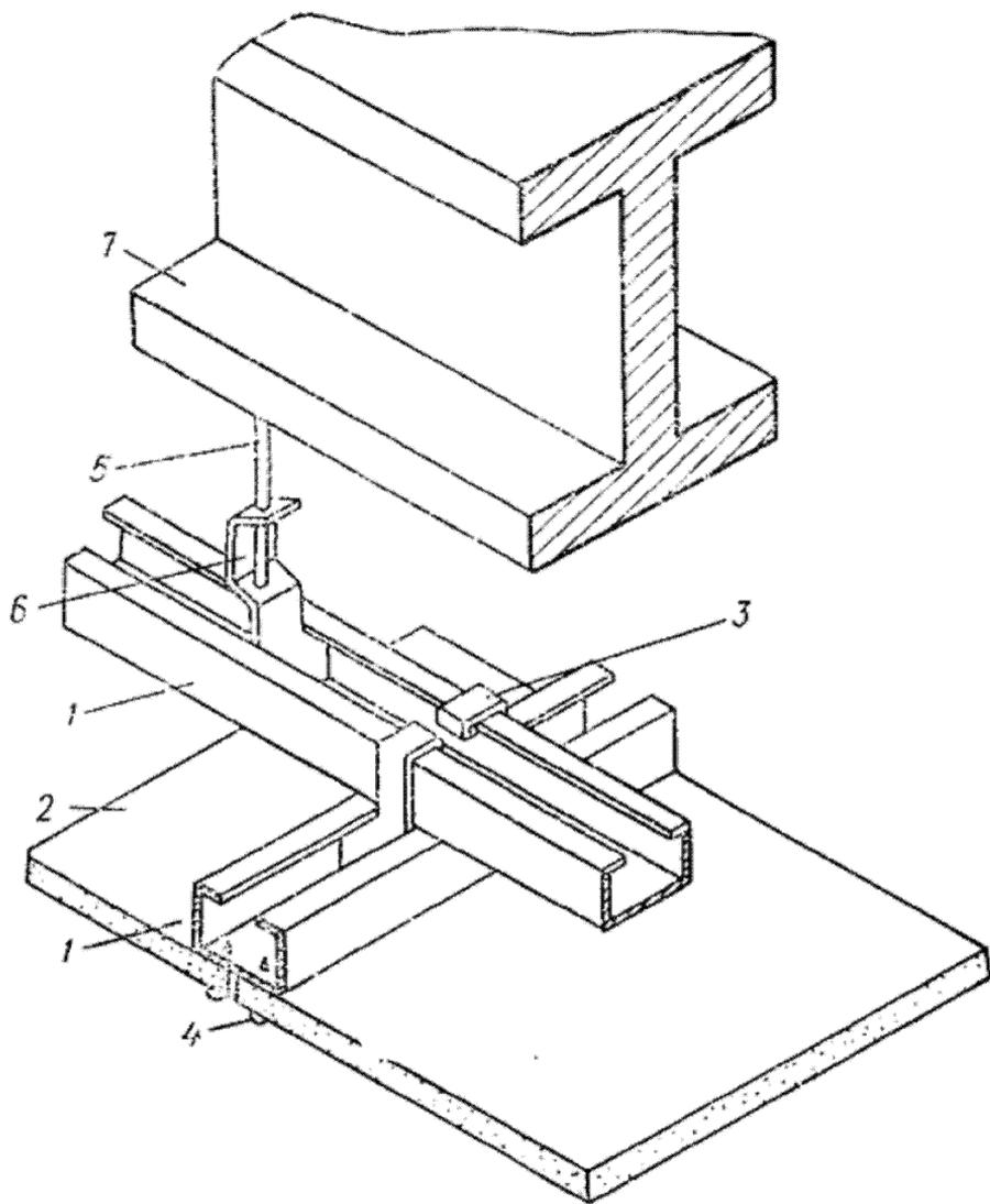
Рисунок 4 – Способ огнезащиты конструкций при помощи подвесного потолка:
