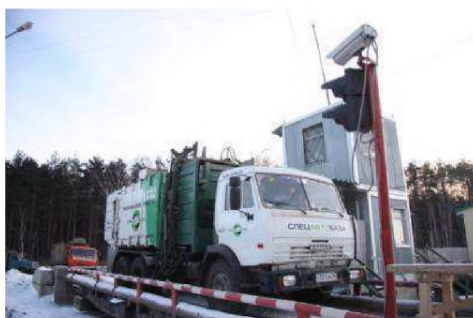
Рисунок 2.15 — Взвешивание отходов, поступающих автотранспортом, с использованием автоматизированной системы учета (Свердловская область)
