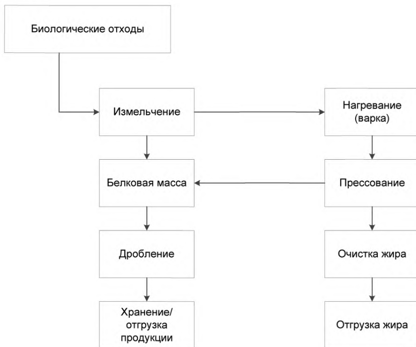
Рисунок 2.19 — Основные стадии технологического процесса утилизации биологических отходов на ветеринарно-санитарных утилизационных заводах и в утилизационных цехах
