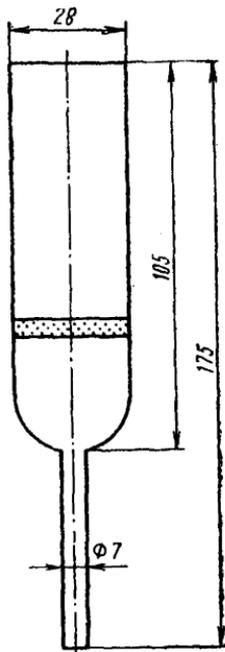
Рис. 10. Воронка с пористой пластинкой
