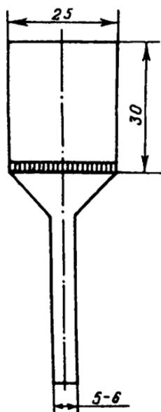
Рис. 7. Воронка стеклянная с пористой пластинкой
