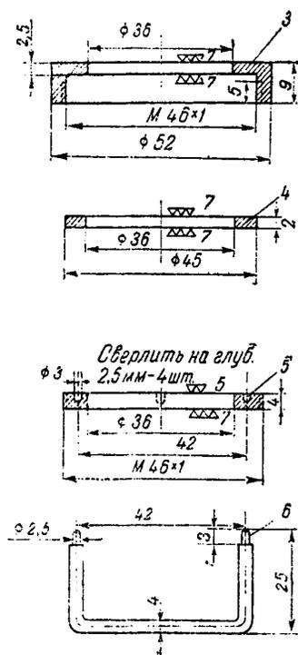
Рис. 3. Металлическая кассета для закрепления фильтров
