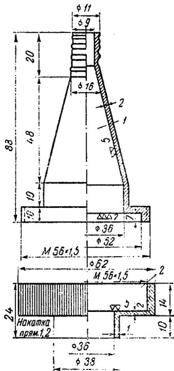
Рис. 2. Металлический патрон, применяемый с кассетой
