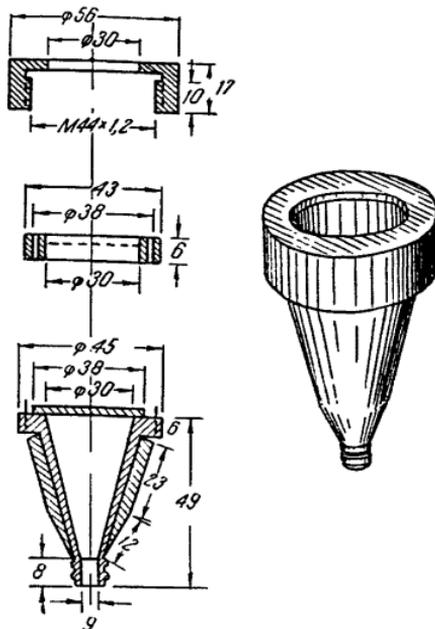
Рис. 13. Плексигласовый патрон для бумажного и других фильтров.
