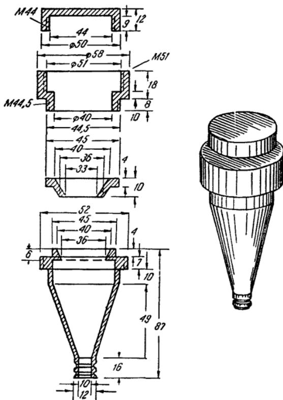
Рис. 12. Металлический патрон для бумажного и других фильтров.
