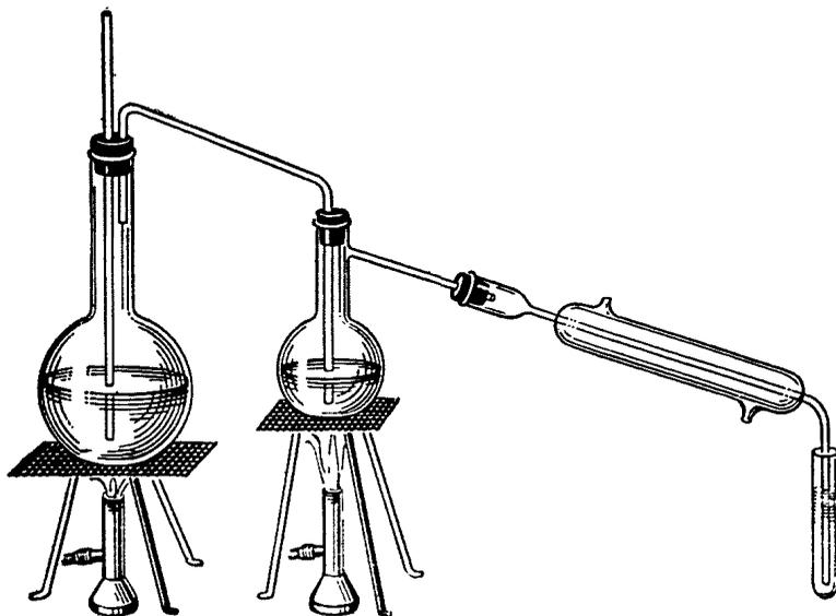
Рис. 13. Прибор для перегонки с водяным паром
