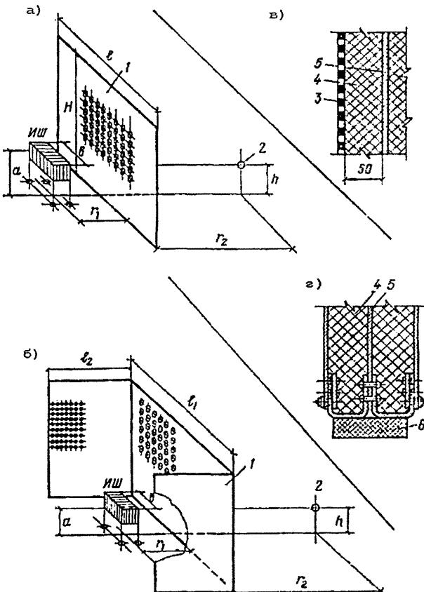
а), б) – формы экрана; в) – конструкция панели экрана; г) – конструкция основания экрана;
