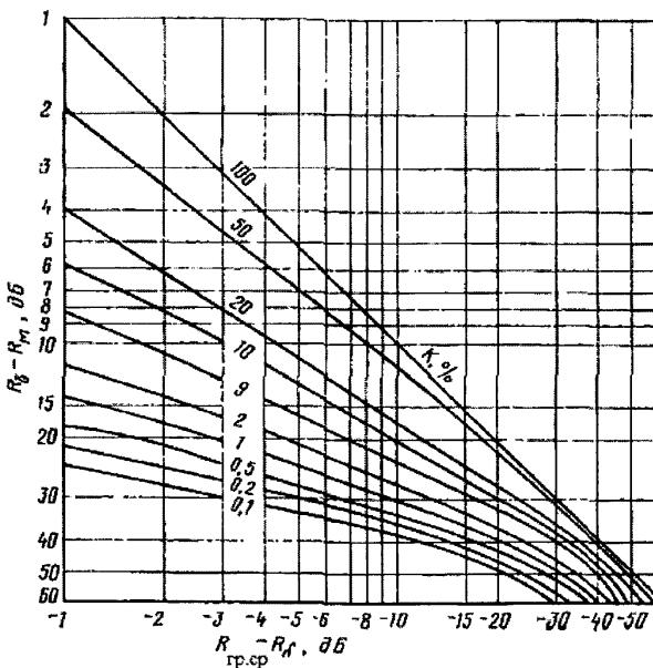
Рисунок 15 – Номограмма для определения средней звукоизоляции неоднородных ограждений
