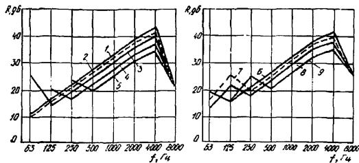
1 – 4x4 м<sup>2</sup>; 2 – 3x3 м<sup>2</sup>; 3 – 2x2 м<sup>2</sup>; 4 – 1x1 м<sup>2</sup>; 5 – 0,5x0,5 м<sup>2</sup>; 6 – 4x2 м<sup>2</sup>;
