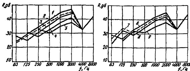
1 – 4x4 м<sup>2</sup>; 2 – 3x3 м<sup>2</sup>; 3 – 2x2 м<sup>2</sup>; 4 – 1x1 м<sup>2</sup>; 5 – 0,5x0,5 м<sup>2</sup>; 6 – 4x2 м<sup>2</sup>;
