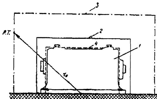
1 – источник шума; 2 – кожух; 3 – воображаемая поверхность площадью  $S_0$ , проходящая через расчетную точку; 4 – воображаемая поверхность площадью  $S_{ист}$ , вплотную окружающая источник шума
