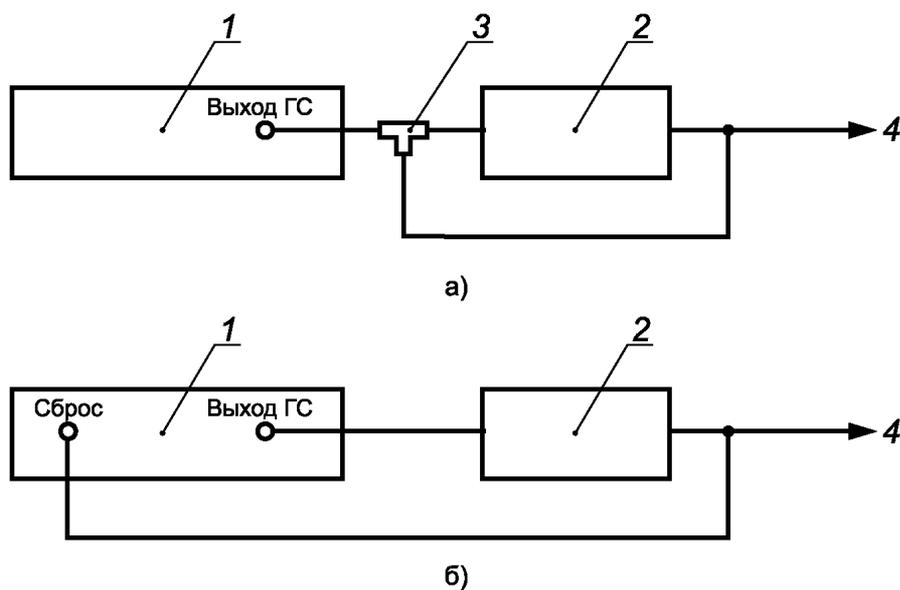
1 — поверяемый генератор, 2 — газоанализатор озона, 3 — тройник из фторопласта или стекла, 4 — вытяжное устройство
