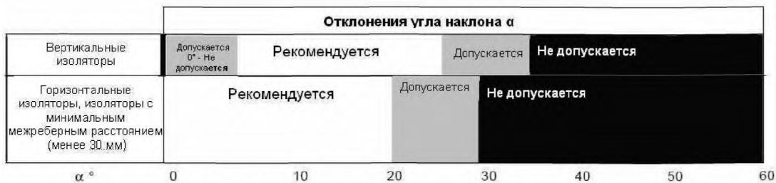
Рисунок 15 — Рекомендации по выбору угла наклона ребра
