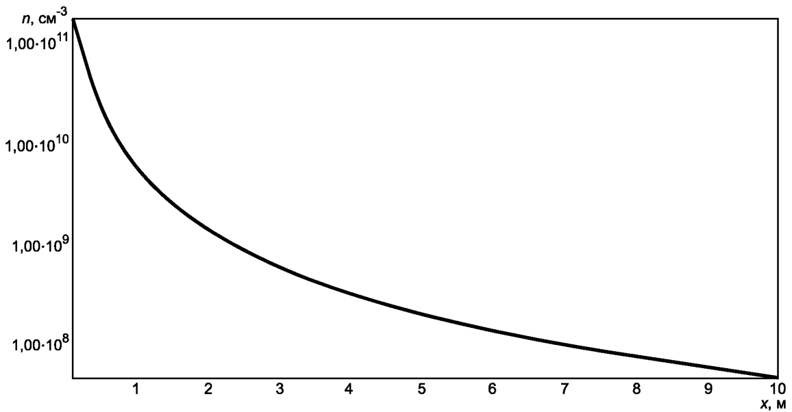
Рисунок Б.8 — Распределение концентрации плазмы n , \text{cm}^{-3} , в струе двигателя СПД-70 вдоль оси струи (логарифмическая шкала)
