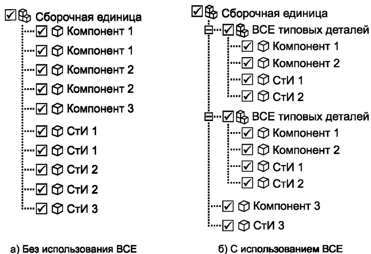
Рисунок 1 — Пример выполнения структуры сборочной единицы
