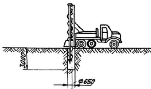
*Рис. 3-1 Бурение котлованов машиной МРК-2*
