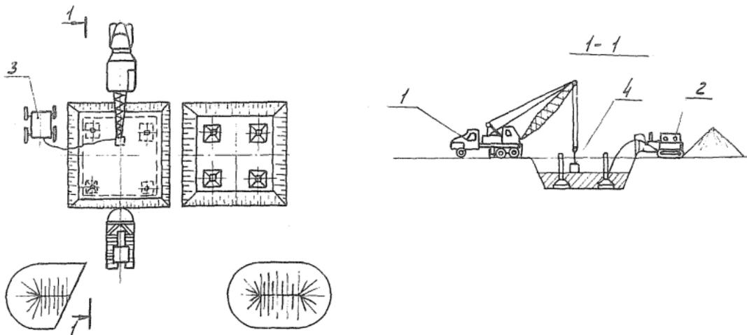
Рис. 3-1. Схема обратной засыпки котлованов под фундаменты опор ПС 750
