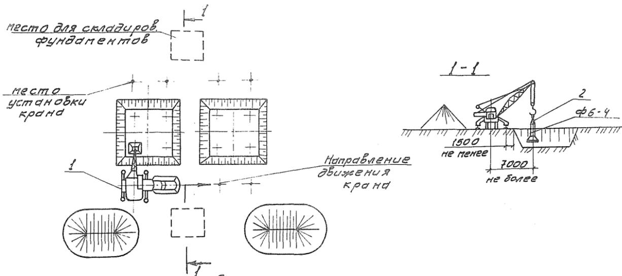
Рис. 2-2. Схема установки ж.б. фундаментов в грунтах II группы
