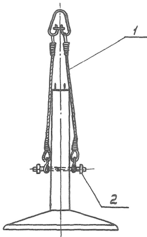
Рис.2-3 Схема строповки фундаментов
