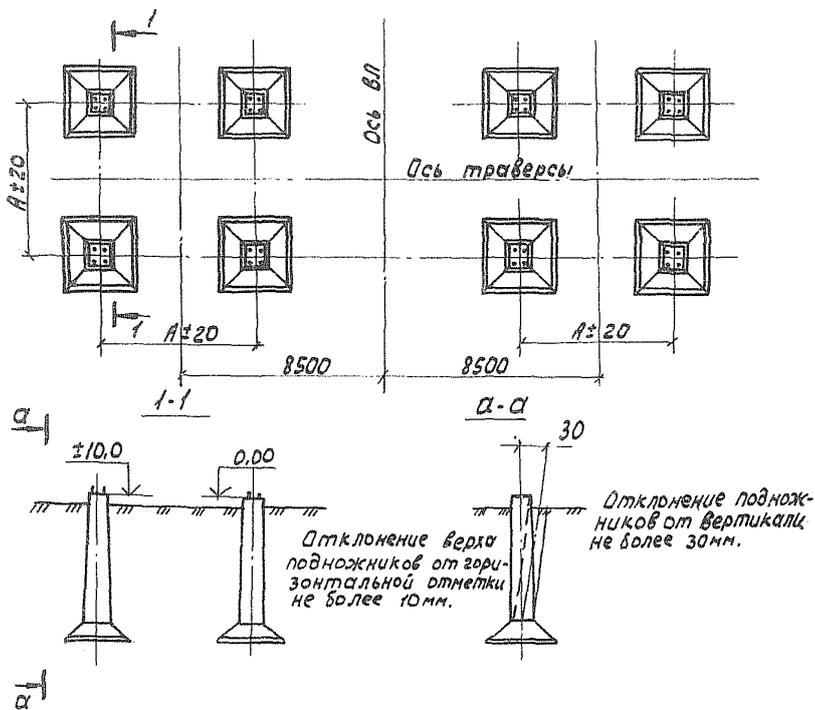
Рис. 2-5. Допускаемые отклонения при монтаже фундаментов под опору типа пс 750
