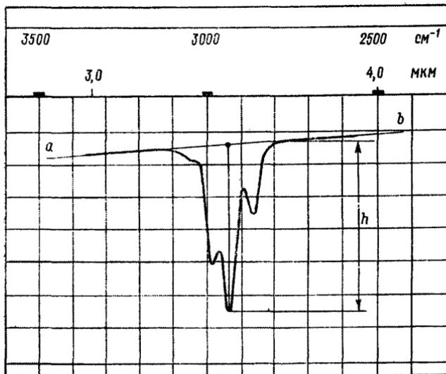
a-b – базисная линия, h – высота опорного пика (полосы поглощения)
