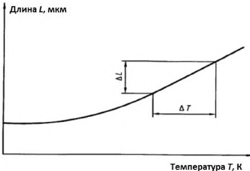
Рисунок 2 – Определение среднего коэффициента линейного теплового расширения  $\bar{\alpha}$
