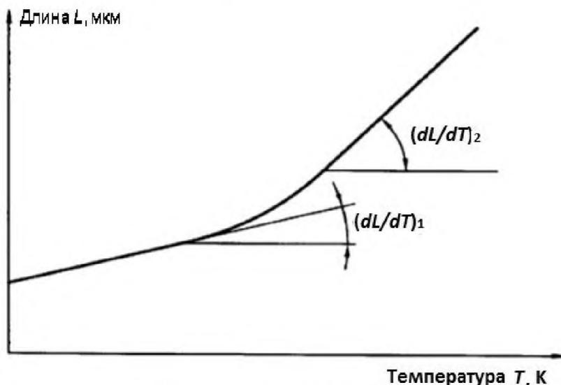
Рисунок 1 – Определение коэффициента линейного теплового расширения
