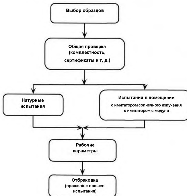
Рисунок 1 – Порядок проверки работоспособности автономной фотоэлектрической системы
