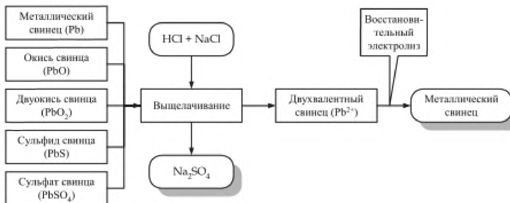
Рисунок 4 - Электрохимические процессы при гидрометаллургическом производстве свинца
