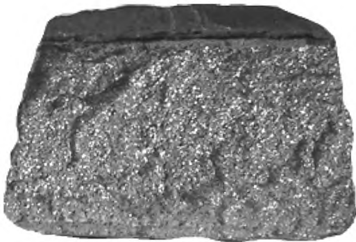
Рисунок Б.10 — Излом мелкозернистый, кристаллический
