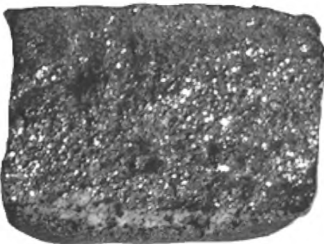
Рисунок Б.12 — Излом среднезернистый, кристаллический
