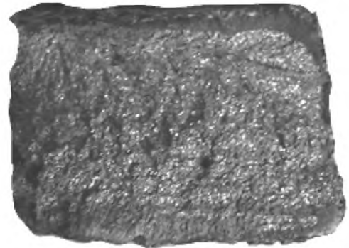
Рисунок Б.11 — Излом мелкозернистый, кристаллический
