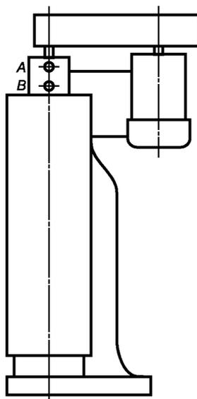
Рисунок 6 — Точки измерения вибрации для трубчатых центрифуг
