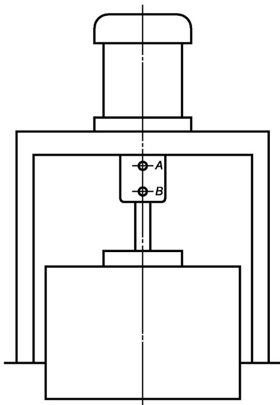
Рисунок 3 — Точки измерения вибрации для подвесных центрифуг
