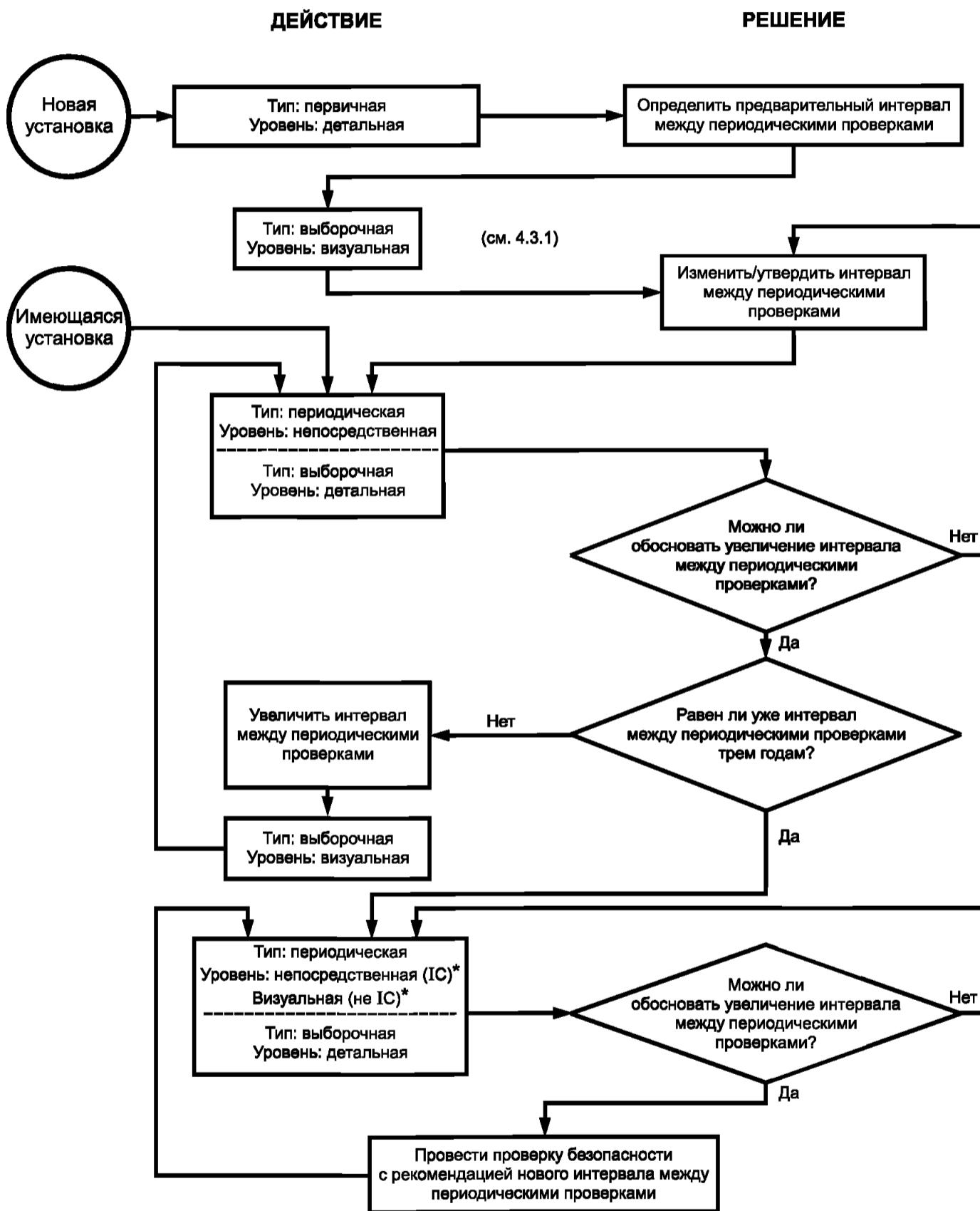
\* IC — способность к воспламенению в обычном режиме работы, т. е. когда в обычном режиме работы встроенных компонентов электрооборудования возникают способные к воспламенению взрывоопасной среды дуговые разряды, искры или температура поверхности.
