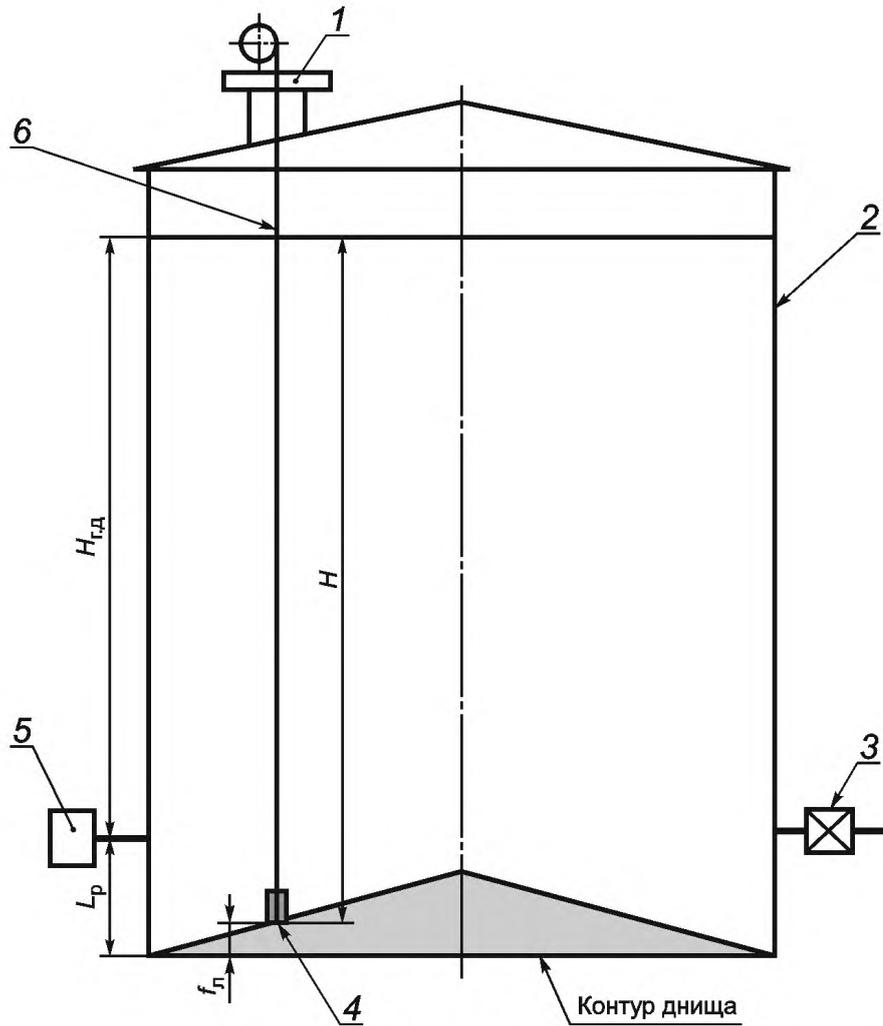
1 — измерительный люк; 2 — цилиндрическая часть резервуара; 3 — приемно-раздаточный патрубок; 4 — груз измерительной рулетки; 5 — преобразователь гидростатического давления; 6 — измерительная рулетка с грузом;  $H_{г.д}$  — уровень гидростатического давления;  $H$  — уровень мазута в резервуаре;  $f_{п}$  — высота точки касания днища грузом рулетки;  $L_{п}$  — высота монтажа преобразователя гидростатического давления
