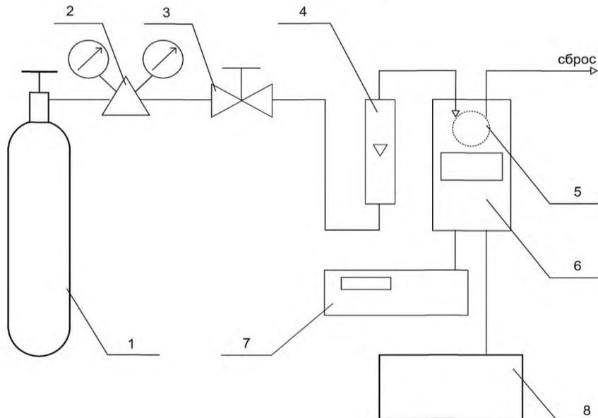
1 – баллон с ГС; 2 – редуктор; 3 – вентиль точной регулировки; 4 – ротаметр; 5 – насадка для подачи ГС; 6 – поверяемый ПИП; 7 – вторичный прибор / персональный компьютер / блок контроля и управления; 8 – источник питания.
