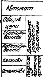
Диаграмма работы контактов Ключ управления „SA“
