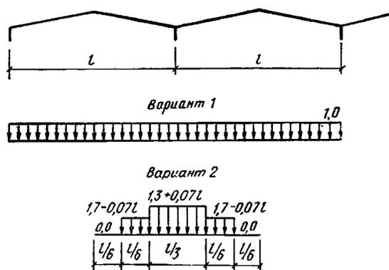
При  $\alpha \leq 25^\circ$  коэффициент перехода равен 1, при  $\alpha \geq 60^\circ$  равен 0; промежуточные значения определяются интерполяцией.
