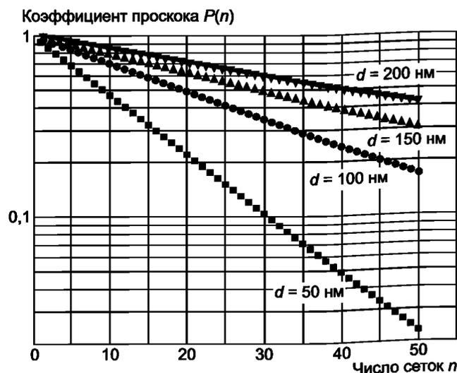
Рисунок А.2 — Теоретическая зависимость коэффициента проскока частиц размерами от 50 до 200 нм от числа сеток при скорости потока аэрозоля  $1 \text{ дм}^3/\text{мин}$
