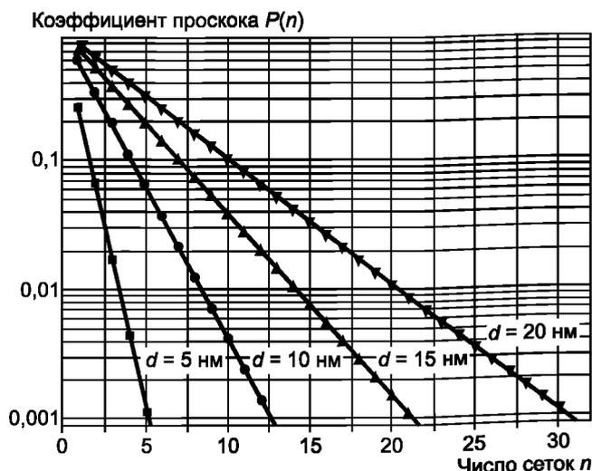
Рисунок А.1 — Теоретическая зависимость коэффициента проскока аэрозольных частиц размерами от 5 до 20 нм от числа сеток при скорости потока аэрозоля  $1 \text{ дм}^3/\text{мин}$
