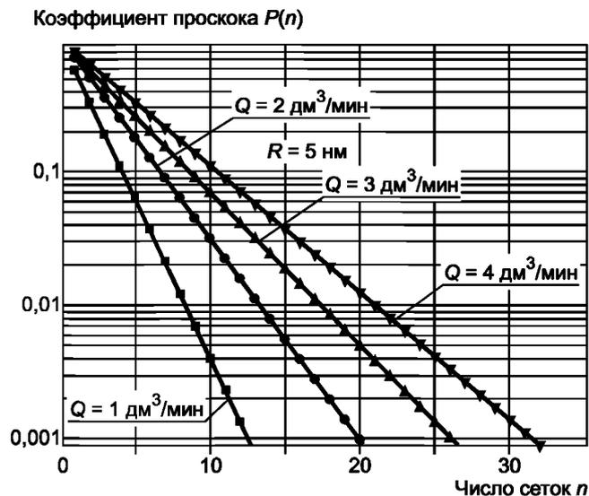
Рисунок В.1 — Зависимость коэффициента проскока аэрозольных частиц размером 10 нм от числа сеток в диффузионной батарее при объемных скоростях 1, 2, 3 и 4 дм<sup>3</sup>/мин
