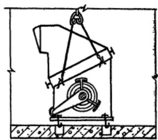
Установка агрегата на место
