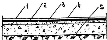
1- покрытие из линолеума; 2- прослойка из битумной мастики; 3- цементно-песчаная стяжка; 4- бетонный подстилающий слой; 5- грунт основания
