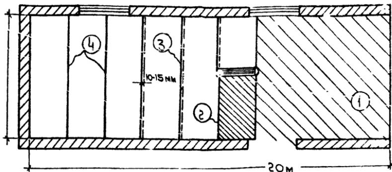
1- огрунтованное основание; 2- прослойка из битумной мастики; 3- наклеенный на основание линолеум (без прорезки кромок) 4- прорезка и приклейка кромок
