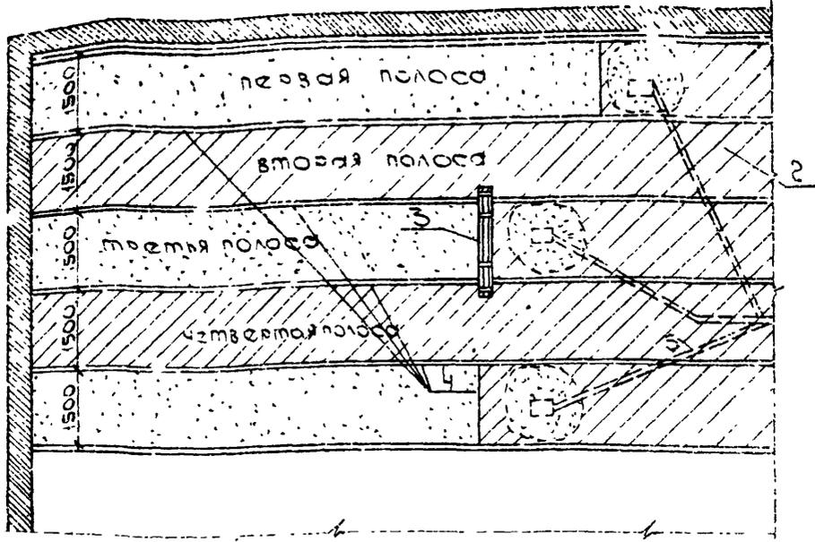
1-цементно-песчаное покрытие, 2-подстилающий слой из бетона, 3-рейка-правило, 4-маячные рейки, 5-гибкий шланг растворовода от установки машины С-862;
