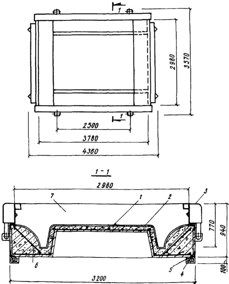
Рис. 12. Форма для изготовления стеновых панелей
