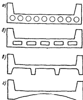
Рис. 2. Сечение железобетонной формы
