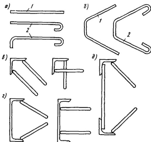
Рис. 4. Крепление анкеров к элементам обрамления
