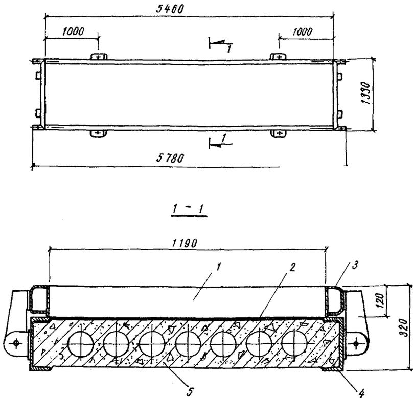
Рис. 9. Форма для изготовления плоских плит
