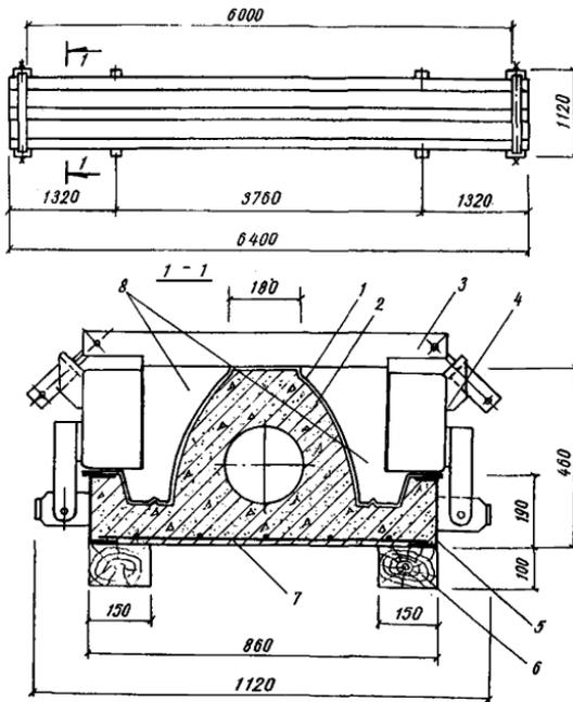
Рис. 7. Форма для изготовления элементов ограждения лоджий
