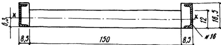
Рис. 15. Расчетное сечение формы
