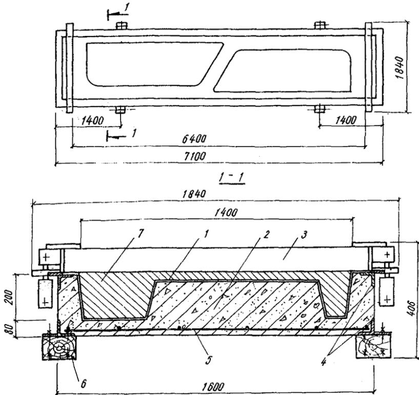
Рис. 10. Форма для изготовления панелей ограждения лоджий
