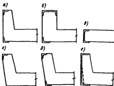
а - из уголков в двух уровнях; б - с верхним оформлением из швеллера; в - из швеллера по высоте поддона; г - с одним верхним оформлением из уголка; д - с дополнительным элементом оформления в месте расположения строповочной скобы из уголка; е - то же, из швеллера
