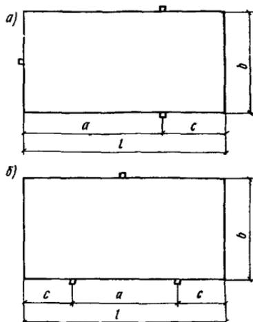
Рис. 6. Схемы расположения трех опор
