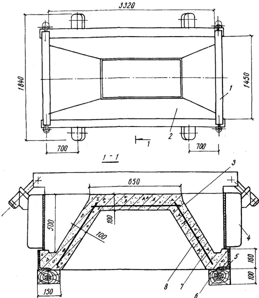
Рис. II. Форма для изготовления стеновых панелей
