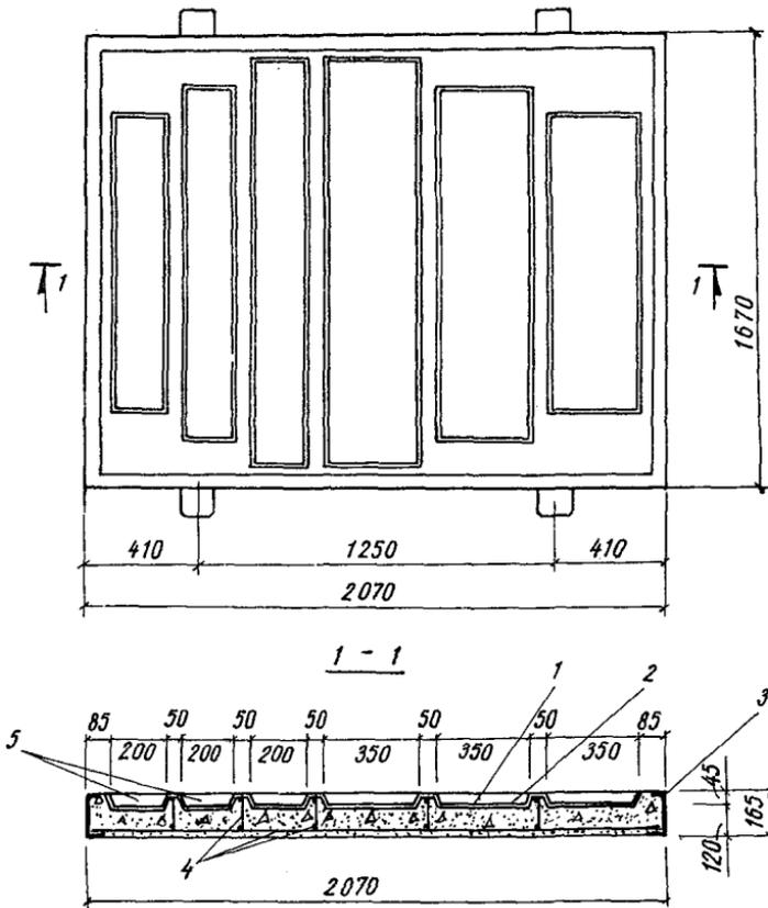
Рис. 8. Форма для изготовления подоконных досок
