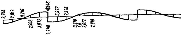
Рис. 45. Эпюры поперечных сил  $Q_D^p$  от расчетных динамических нагрузок при  $\omega = \rho_3$
