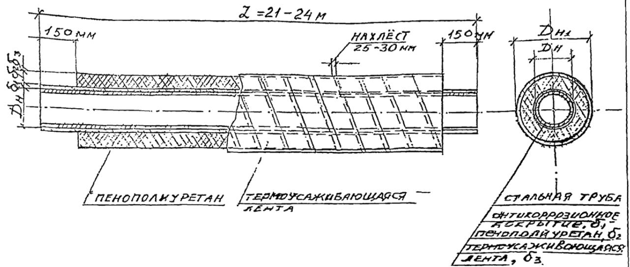
Рис. ТЕПЛОИЗОЛИРОВАННАЯ ДВУХТРУБНАЯ СЕКЦИЯ
