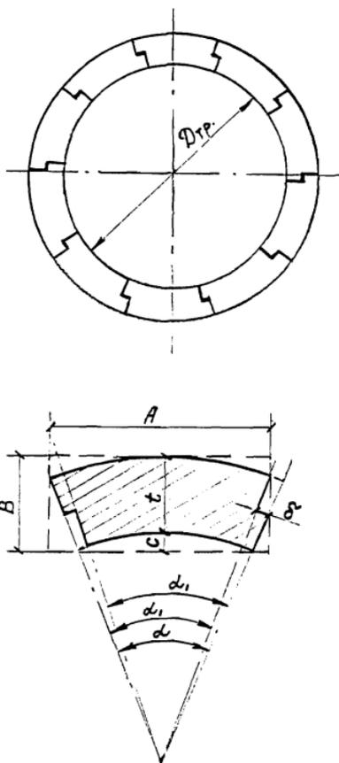
Рис. 1. Геометрические размеры плит-заготовок
