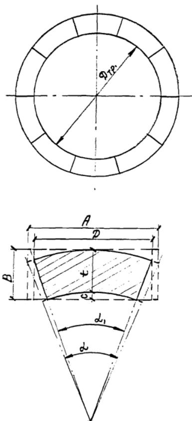
Рис.2. Геометрические размеры плит-заготовок
