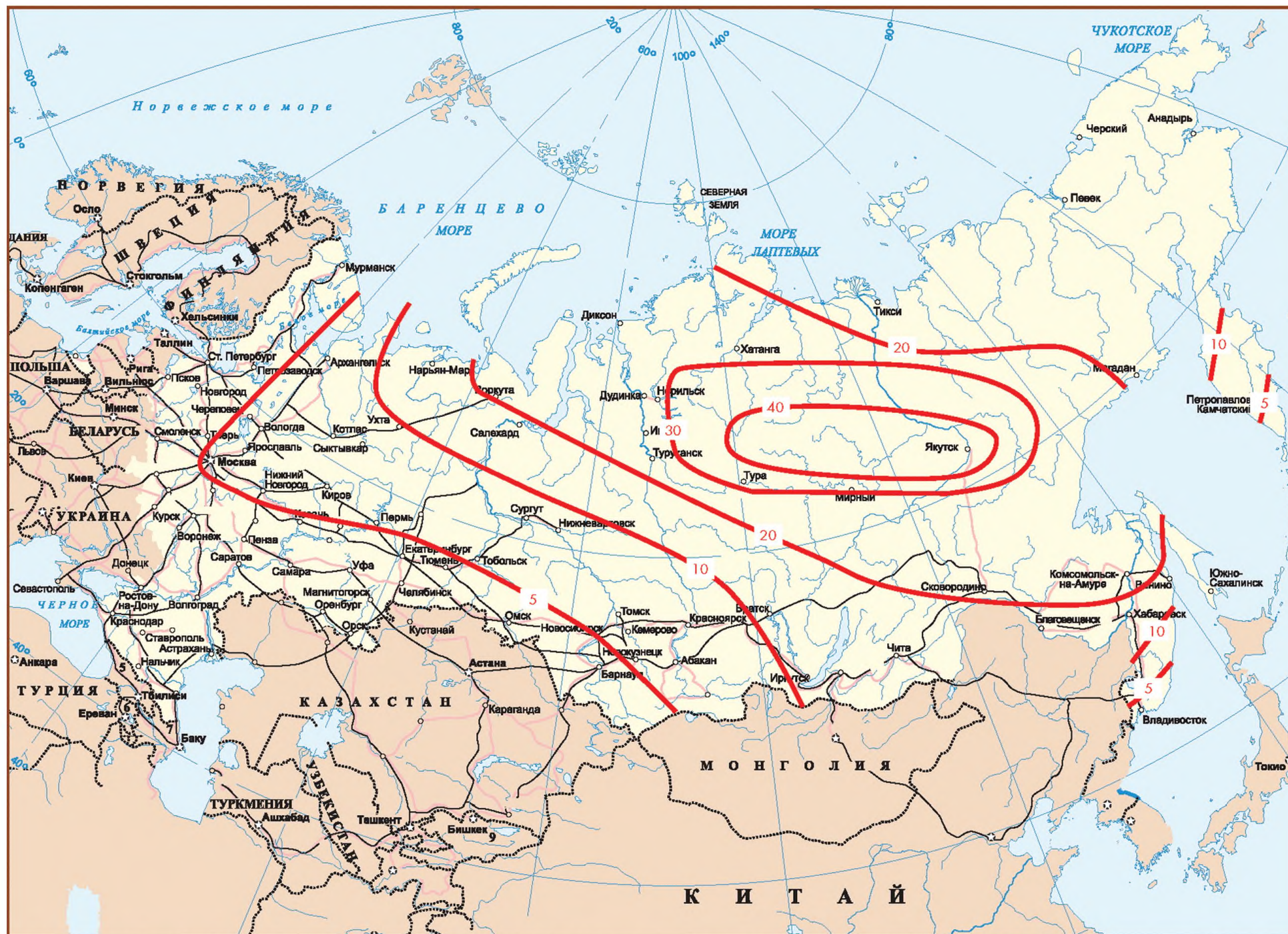
Рисунок Ж.8 — Районирование территории Российской Федерации по эффективности использования низкопотенциальной тепловой энергии поверхностных слоев Земли для теплоснабжения. (Изолинии на карте — доля тепловой энергии, вырабатываемой в течение года ПД в суммарных годовых энергозатратах системы «вертикальная» ГТСТ+ПД, %)
