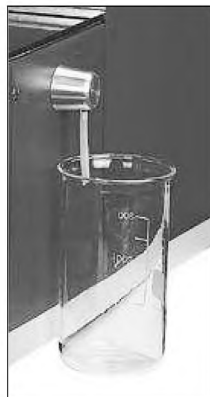
Рисунок 2 — Контейнер-приемник для отходов
